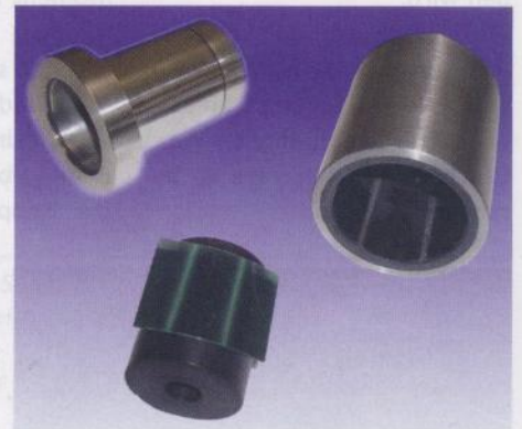
Der Kupplungsrotor im Bild ist komplett mit PTFE ummantelt, daneben sind der Spalttopf aus Hastelloy und das Kupplungs-Außenteil zu sehen
